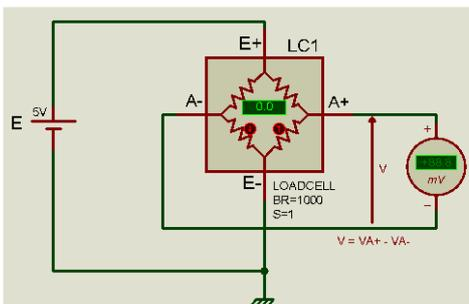
Modifier les propriétés de «LC1» afin de les rendre conformes à notre capteur.
