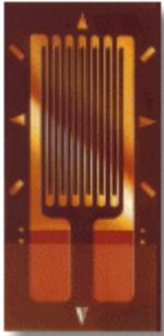
Le but des extensomètres à fils résistants ou jauges de déformation (ou, abusivement, jauges de contrainte) est de traduire la déformation d'une pièce en variation de résistance électrique (plus les extensomètres s'étirent, plus leurs résistances augmentent).
